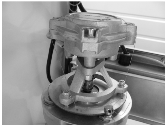
Рисунок В.1 – Схема пломбировки генератора импульсов, производства фирмы «Zhejiang Daitian Machine Co., Ltd.» с измерителем объема СУГ
