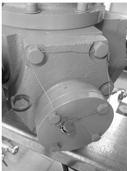
Рисунок В.2 – Схема пломбировки измерителя объема СУГ
